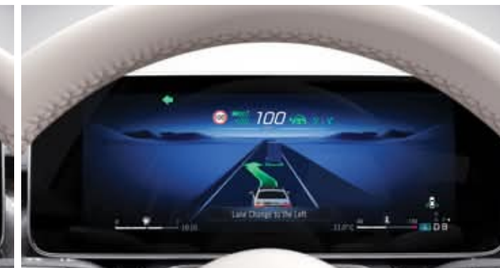
Evasive Steering Assist ระบบช่วยการทรงตัวและดึงรถกลับเข้าช่องจราจร ขณะหลบเลี่ยงสิ่งกีดขวางฉุกเฉิน
