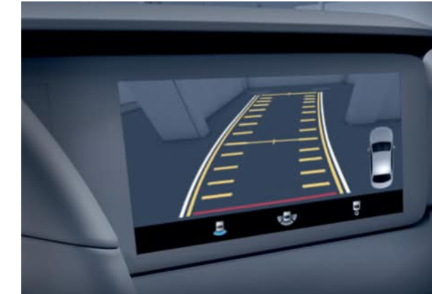
Parking Package with reversing camera ระบบช่วยการนำรถเข้าจอดอัตโนมัติ พร้อมกล้องแสดงภาพขณะถอยจอด
